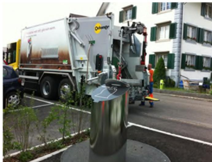
Kehrichtfahrzeug mit Rollcontainer-Hubvorrichtung und zusätzlichem Kran (bivalente Nutzung)
