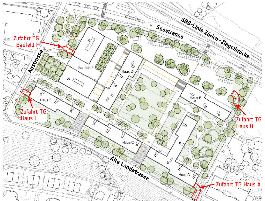
Abb. 3: Grundrisse der geplanten Gebäude, Situation 1:2'500. TG = Tiefgarage
