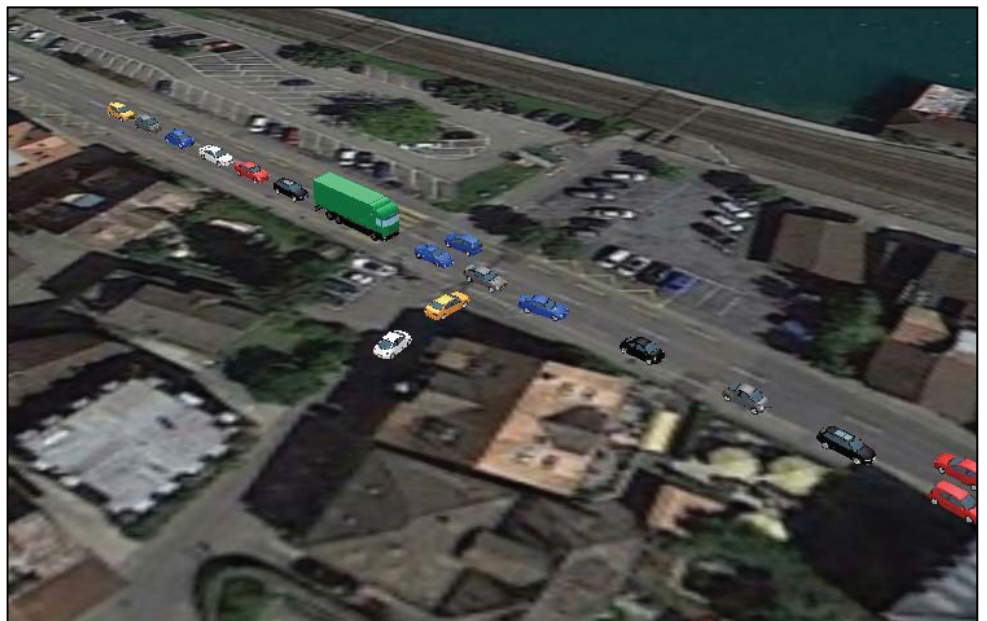
Auszug Verkehrsflusssimulation VISSIM, Einmündung Floraweg/Seestrasse
