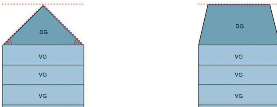
Abbildung 19 Erscheinung des Daches gemäss der aktuellen Regelung (links) und gemäss IVHB (rechts)
