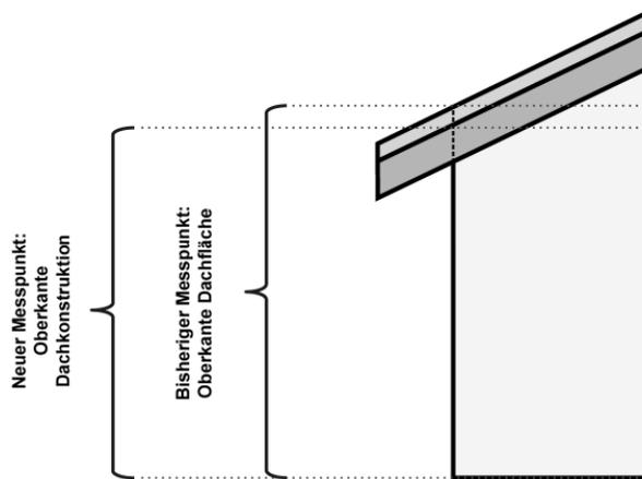
Abbildung 18 Änderung des Messpunkts Gebäudehöhe vs. traufseitige Fassadenhöhe
