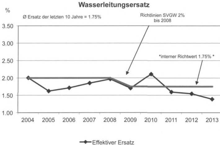
\* Mit dem Einsatz von Kunststoffleitungen im Netz verlängert sich die theoretische durchschnittliche Lebenserwartung der Kunststoffleitungen auf 80 Jahre. Mit einem Anteil von ca. 35% solcher Leitungen im Wassernetz ergibt sich ab dem Jahr 2009 eine jährliche Erneuerungsrate von 1.75%.
