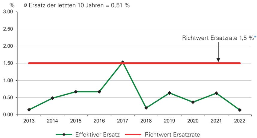
\*Mit dem Einsatz von Kunststoffleitungen im Netz verlängert sich die theoretische durchschnittliche Lebenserwartung der Leitungen auf 70 – 80 Jahre. Mit einem Anteil von ca. 75 % solcher Leitungen im Gasnetz ergibt sich eine durchschnittliche jährliche Erneuerungsrate von 1,5 %, welche in diesem Geschäftsjahr mit lediglich 0,14 %, bewusst nicht ausgeschöpft wurde.
