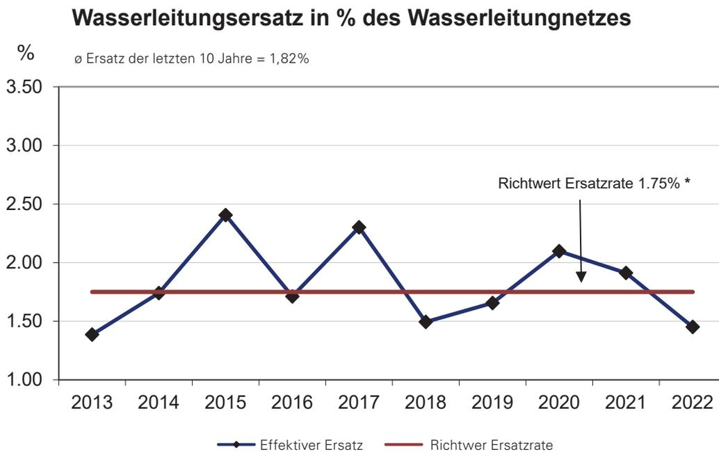
Brancheweite Erkenntnisse haben gezeigt, dass Werkleitungen aus duktilem Guss, die üblicherweise in den Jahren 1970 bis 1985 verlegt wurden, eine massiv kürzere Lebensdauer als geplant aufweisen. In der Wasserversorgung Wädenswil wurden während dieser Zeitperiode ca. 30'000 Laufmeter solcher Rohre verlegt. Dadurch erhöht sich die Erneuerungsrate in den kommenden Jahren deutlich. So wurden in diesem Betriebsjahr bereits rund 1,5 % an überalterten Leitungen ersetzt.
